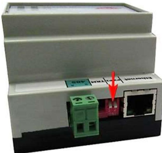
Рисунок 3 – Перевод движковых переключатели в положение ON
