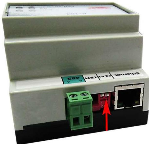
Рисунок 36 – Перевод движковых переключателя в положение OFF
