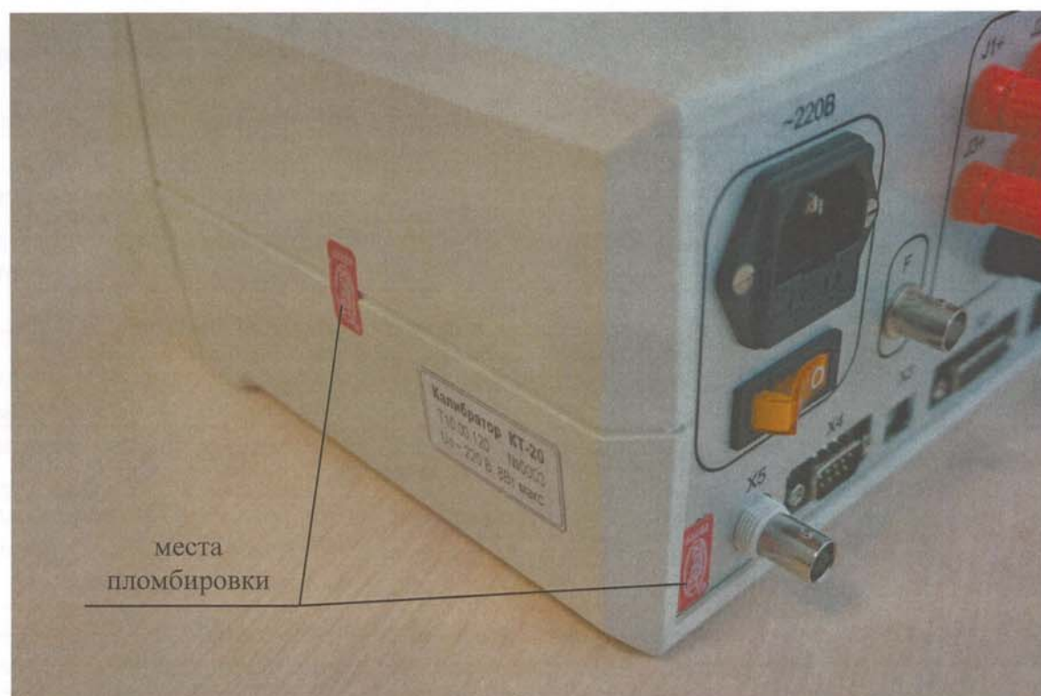
Рисунок 2 – Схема пломбировки от несанкционированного доступа
