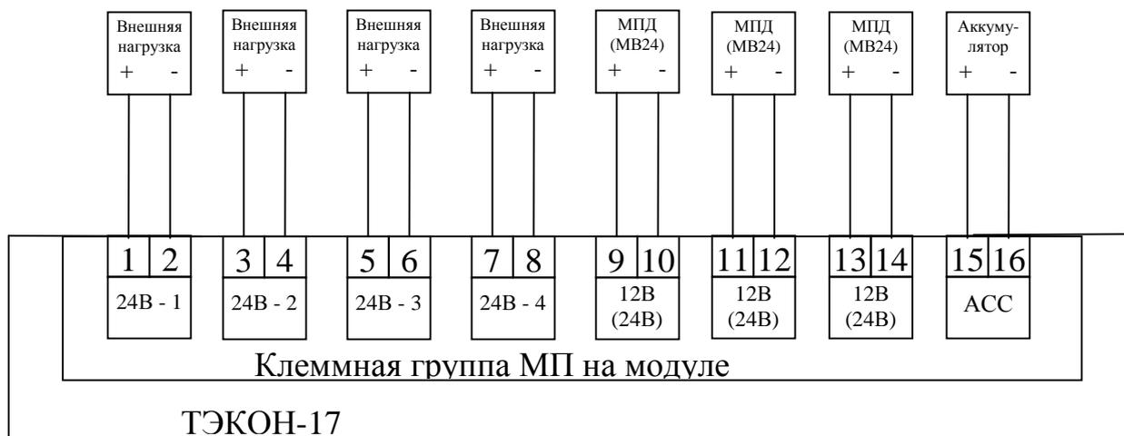
Рисунок 3.8 - Подключение нагрузки к выходам питания на модуле МИ
