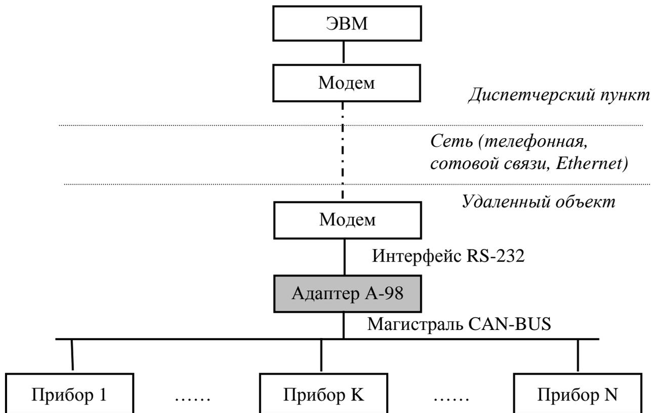
Рисунок 2.1 – Структура системы сбора информации с применением адаптера
