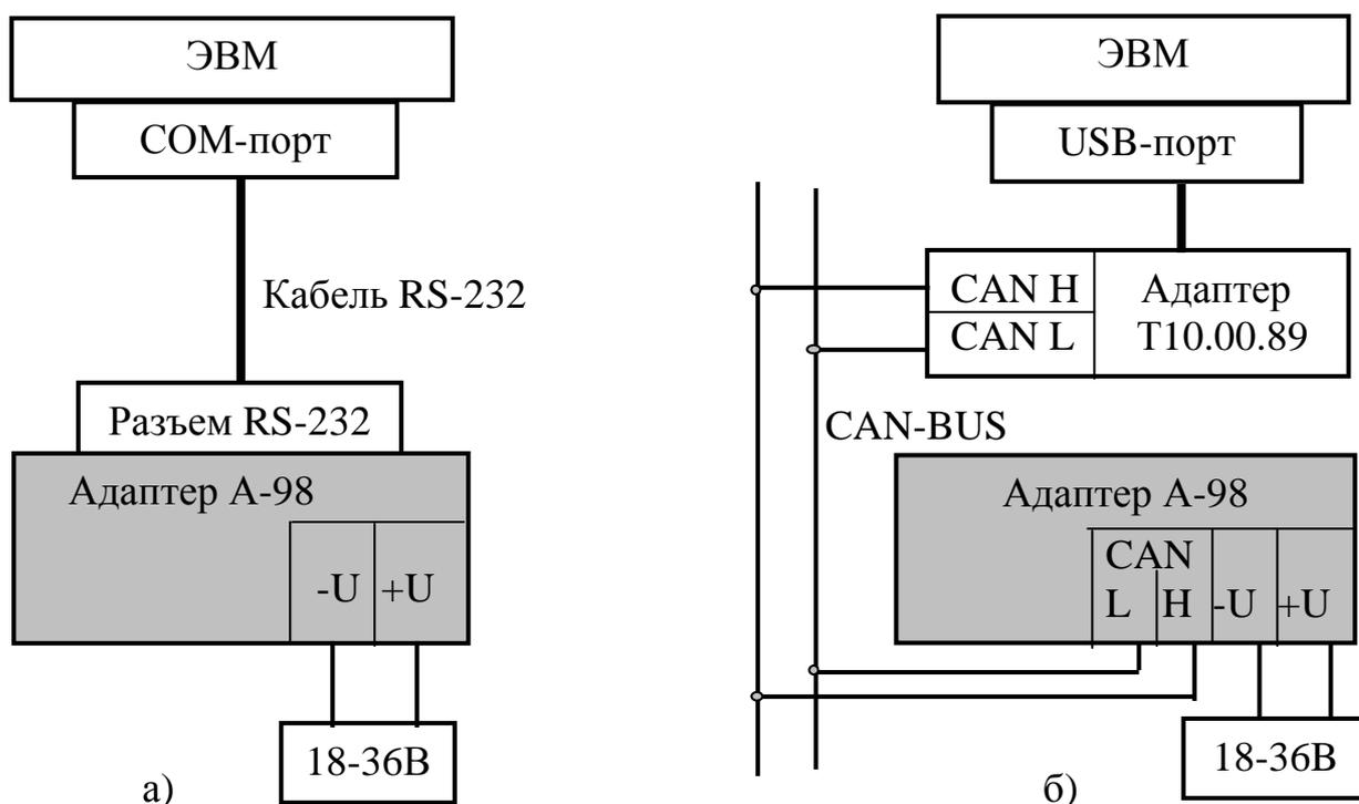
Рисунок 3.1- схема подключения адаптера к ЭВМ при настройке
