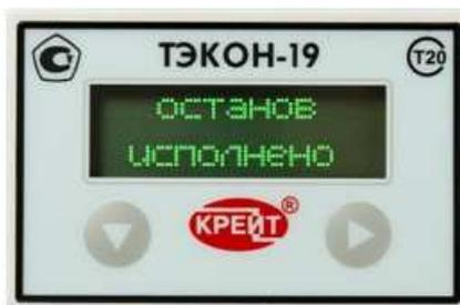
Рисунок 18. Комплекс переведен в режим «Останов»
