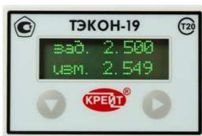
Рисунок 47. Заданные и измеренные значения давления
