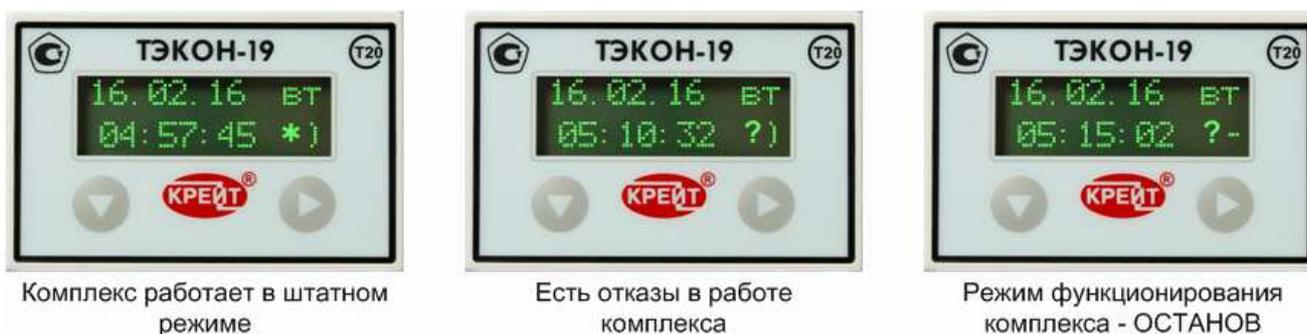
Рисунок 11. Текущие дата/время и индикаторы правильной/неправильной работы комплекса
