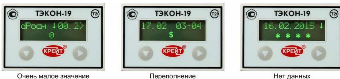
Рисунок 13. Отображение на дисплее значений, отличных от числовых значений диапазона от  $-10^6$  до  $10^7$
