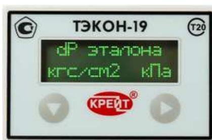
Рисунок 56. Выбор единиц измерения эталонного СИ разности давления
