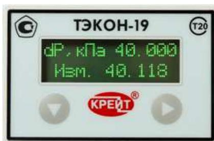
Рисунок 58. Задаваемые и измеренные значения разности давления
