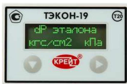
Рисунок 49. Выбор единиц измерения эталонного СИ разности давления
