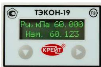
Рисунок 57. Задаваемые и измеренные значения давления
