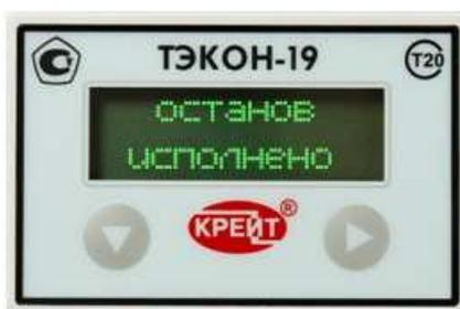
Рисунок 19. Комплекс переведен в режим «Останов»
