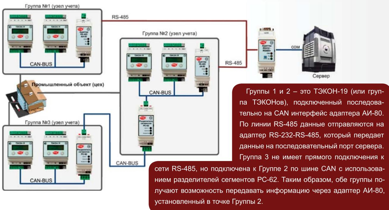
Группы 1 и 2 – это ТЭКОН-19 (или группа ТЭКОНов), подключенный последовательно на CAN интерфейс адаптера АИ-80. По линии RS-485 данные отправляются на адаптер RS-232-RS-485, который передает данные на последовательный порт сервера. Группа 3 не имеет прямого подключения к сети RS-485, но подключена к Группе 2 по шине CAN с использованием разделителей сегментов PC-62. Таким образом, обе группы получают возможность передавать информацию через адаптер АИ-80, установленный в точке Группы 2.
