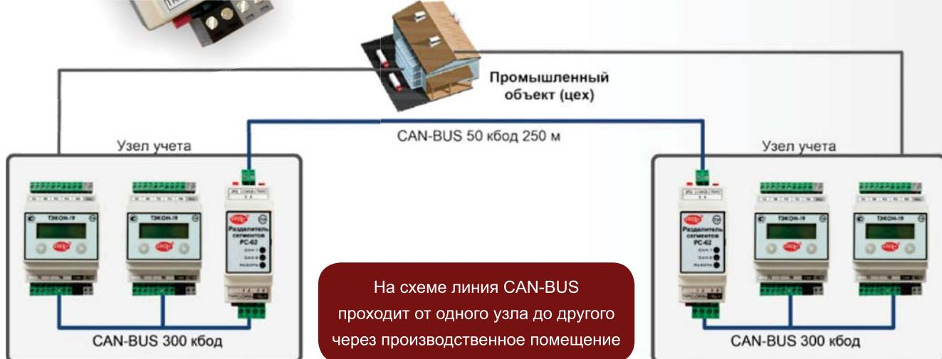
Дополнительная функция PC-62 – ограничение доступа к модулям из одного сегмента к модулям в другом сегменте. С помощью такого решения возможно разграничение доступа к приборам в одной системе между разными юридическими лицами.
